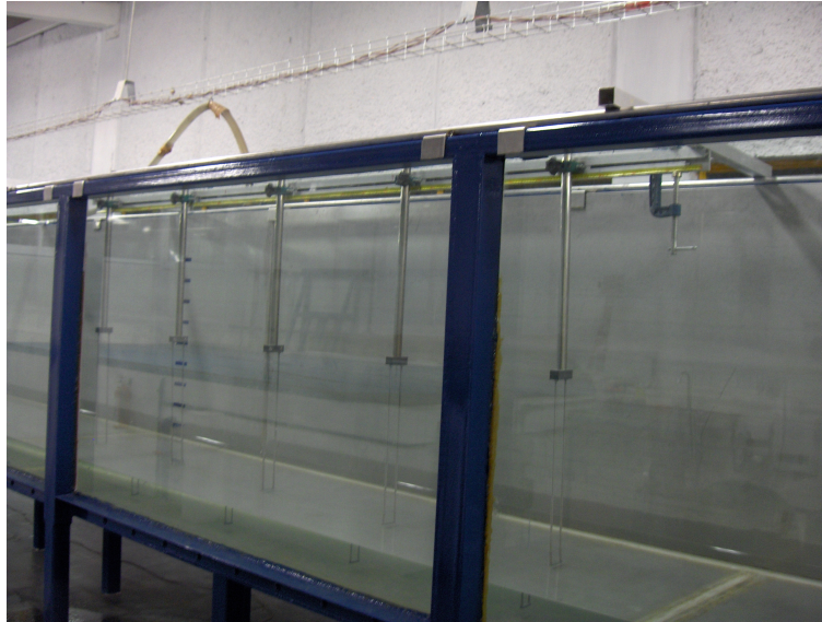
Figura 5.5: Grupo de sensores de nivel montados en un soporte metálico.
