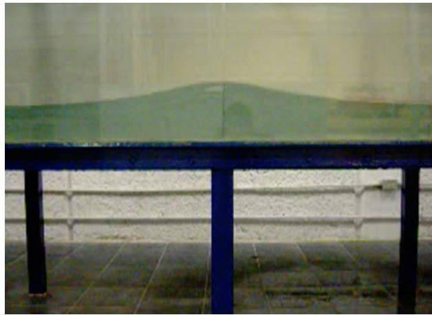
Figura 5.7: Perfil de la onda mayor antes del cruce, A_2 = 7.99\text{ cm} , X_{S1}=6.68\text{ m} .
