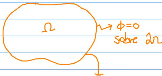
Especifica el potencial sobre  $\partial\Omega$  (conductor)
